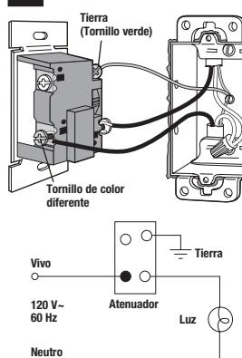
**Note:** Si esta reemplazando un interruptor unipolar con tres vías o unipolar/atenuador tres vías, el tornillo en el mismo lado del tornillo de color diferente no se usa. Apriete y asegurelo.
